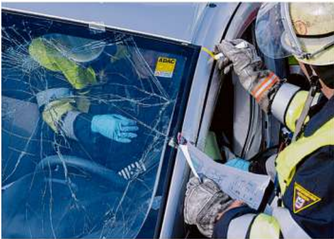
Die Rettungskarte hilft Einsatzkräften dabei, schnell die richtigen Ansatzpunkte für das Bergungswerkzeug zu finden.
